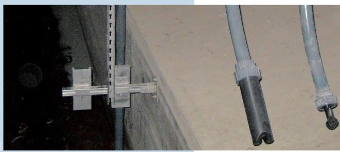
Sondes de turbidité et de conductivité installées dans l'ouvrage de stockage/ décantation Panhard et Levassor à Paris
